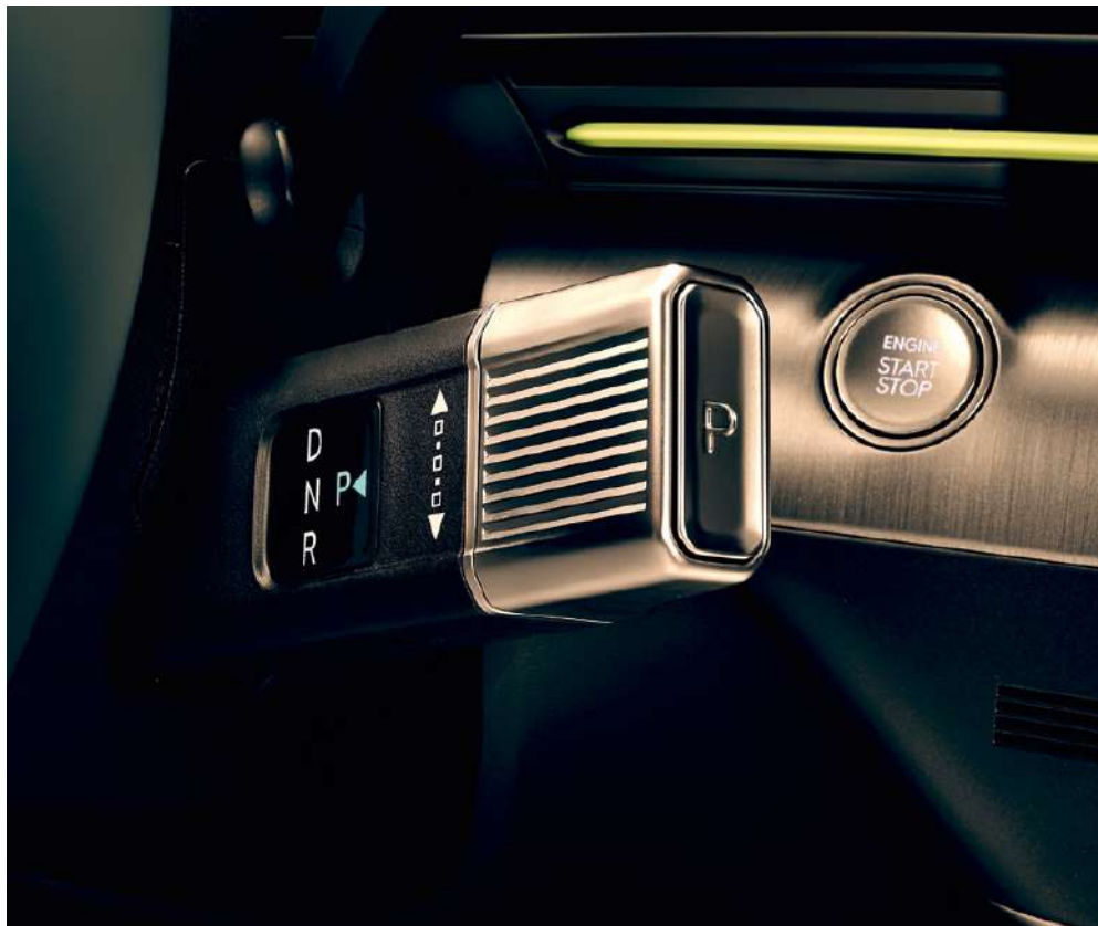
Kormányoszlopra szerelt elektronikus váltókar.
