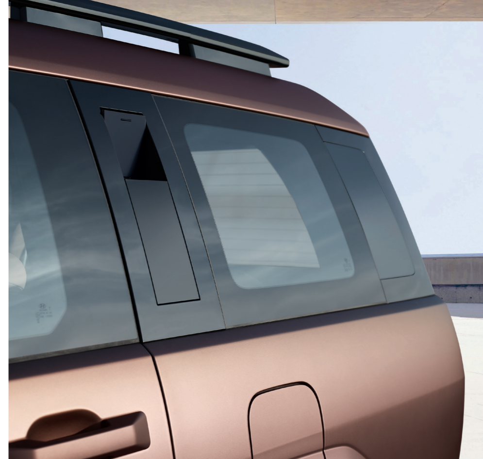
Rejtett kapaszkodó / ablakbetét a hátsó tetőoszlopban
