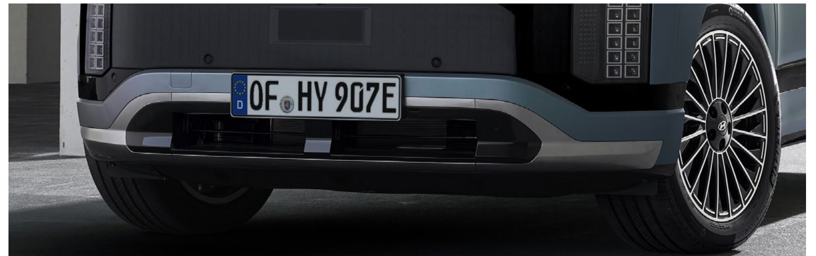
A kettős mozgatású aktív légbevezető csappantyú az áramlástanii jellemzőket és az autó megjelenését egyaránt javítja.
