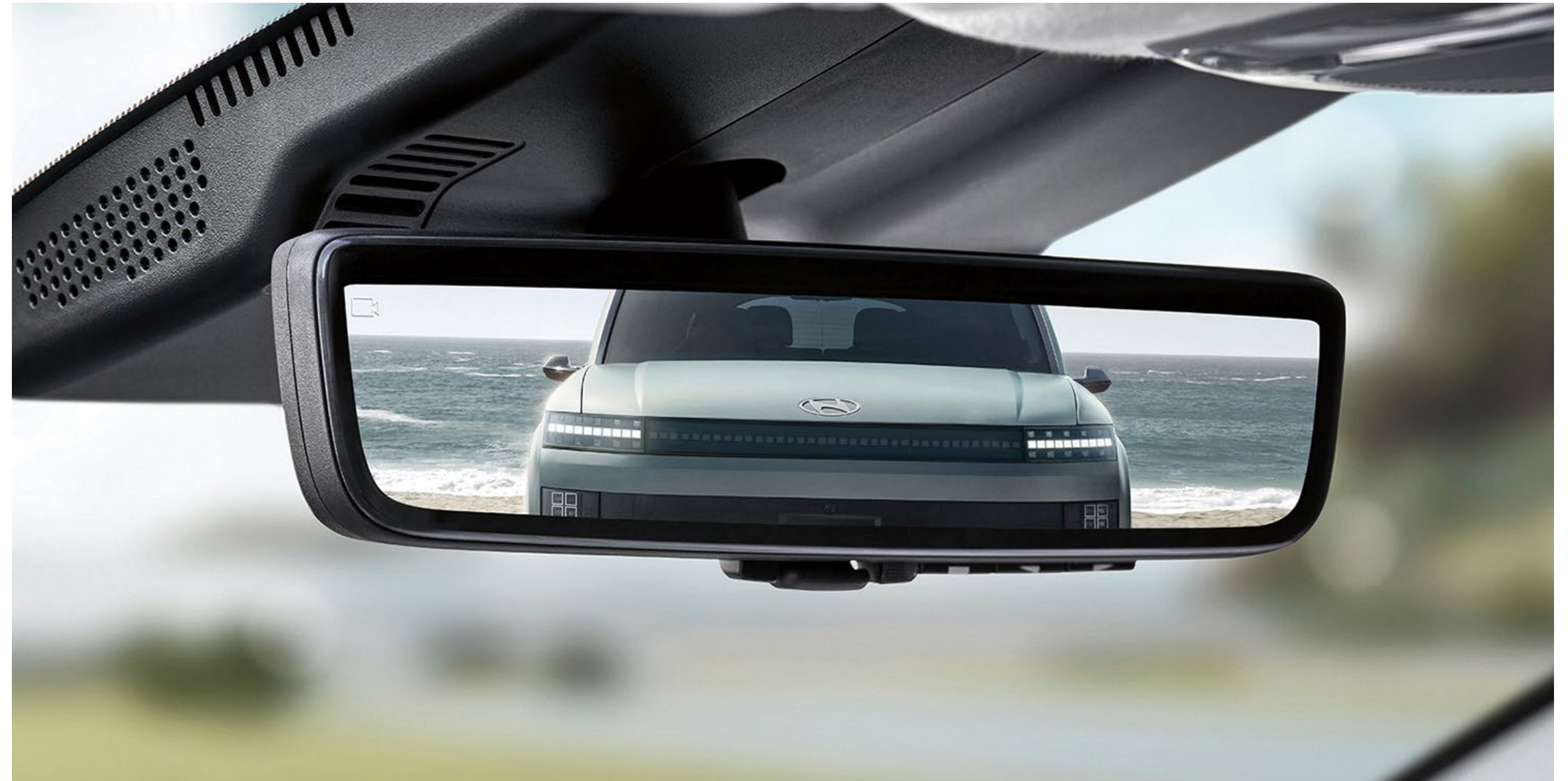
A digitális belső visszapillantó tükrök egy hátul elhelyezett kamera segítségével valós idejű képet közvetít, a hagyományos tükröknél jóval szélesebb látómezővel.
