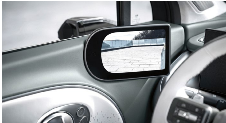
A digitális külső visszapillantó tükrök (DSM) ajtóra szerelt kijelzője.
