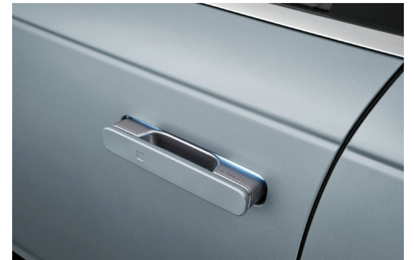
A karosszéria síkjába süllyedő, onnan automatikusan kiemelkedő ajtókilincsek
