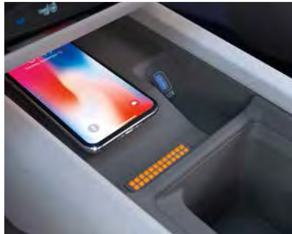
A nagy sebességű, vezeték nélküli telefontöltő parametrikuspixel-kijelzőjéről egyetlen pillantással leolvasható a telefon töltöttségi szintje.
