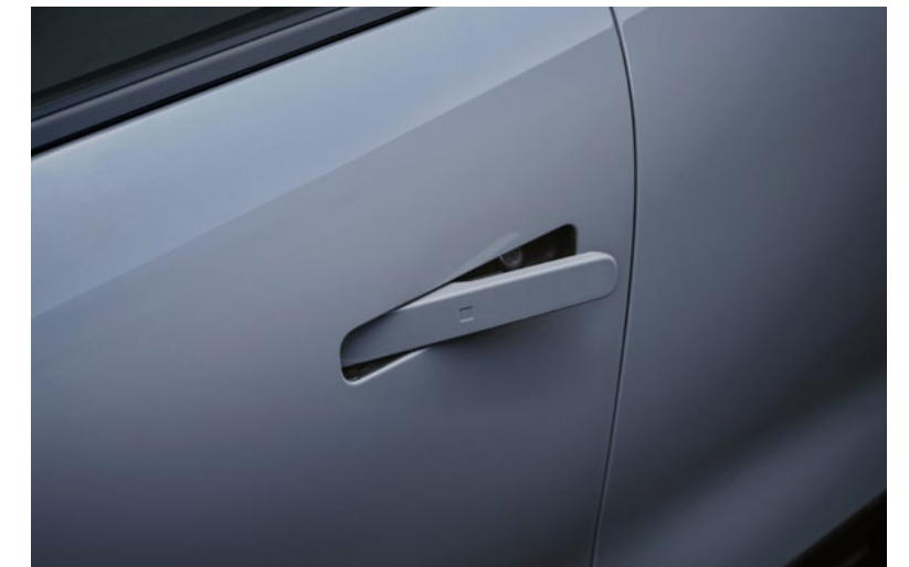
Síkba húzódó automatikus ajtókilincsek.
