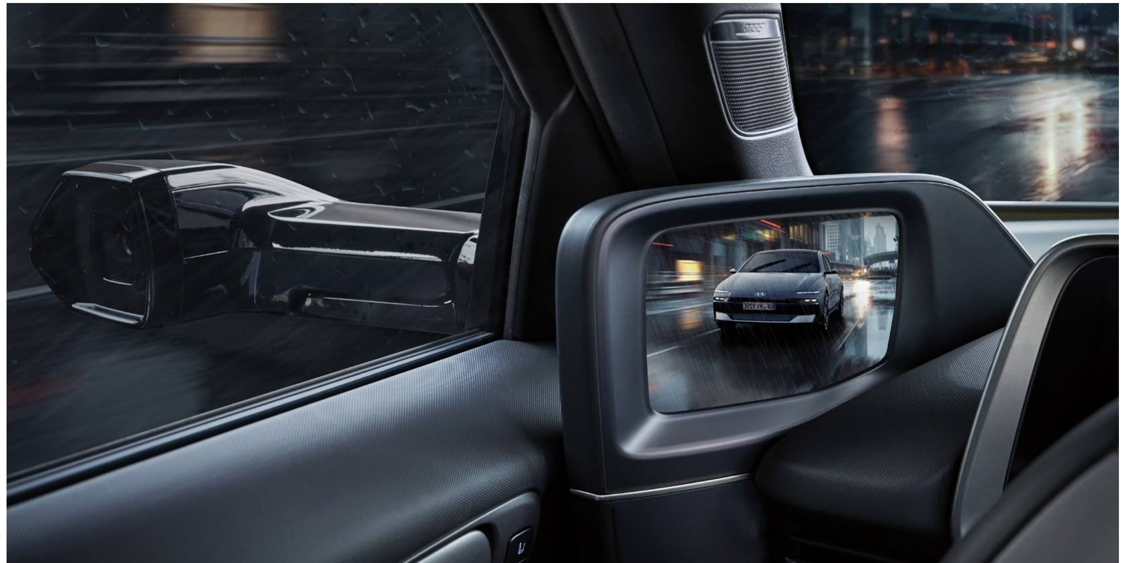
A digitális visszapillantó tükör kamerájának segítségével valós idejű képet közvetít, a hagyományos tükörnél jóval szélesebb látómezővel.
