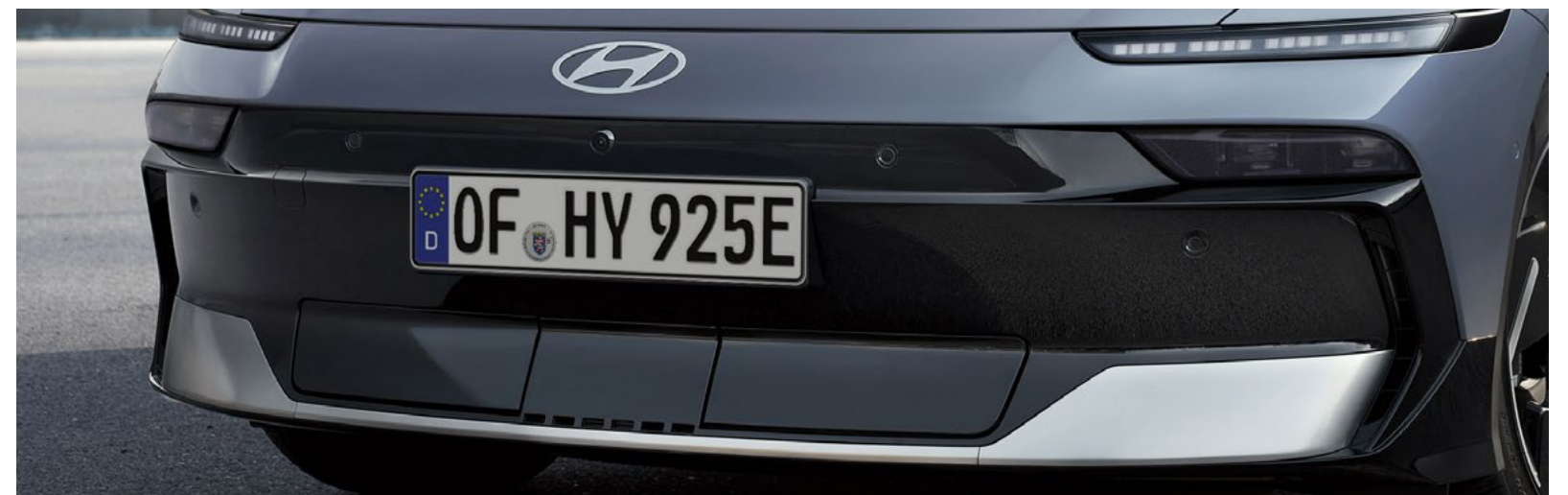
Az aktív lamellák automatikusan nyílnak és záródnak, így biztosítva maximális aerodinamikai hatékonyságot és optimális akkumulátor-hűtést.
